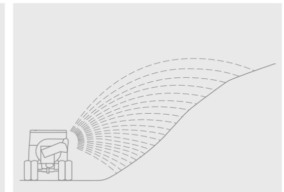
Mit verstellbaren Streuweiten von 3 bis 20 Metern sind die Gafner-Streuer präzise bei jeglichem Einsatz, ob auf steilem Hügel schräg gestreut wird oder liniengenau ab dem Strassenrand.
