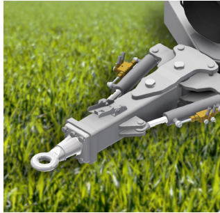
Hydraulische Lenkdeichsel mit Zugöse Timone sterzante idraulico con occhio Steering hydraulic drawbar with towing eye
