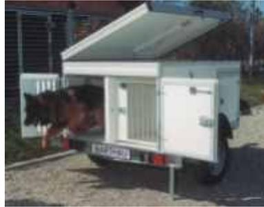
Spritzwasserdichte, zugfreie Außentüren, bis zu 180° weit öffnend, Feststeller am Kotflügel. Alu-Gittertüren serienmäßig.
