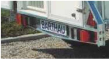
Beleuchtung geschützt angebracht, serienmäßig mit Nebelschlussleuchte und Rückfahrscheinwerfer. Lichtanschluß 12 Volt, 13poliger Eurostecker.
