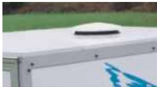
Lüftungsventilator, 12 Volt, Luftleistung 140 m<sup>3</sup>/h bis 180 m<sup>3</sup>/h, stufenlos regelbar, mit Schalterstellung blasen/saugen.
