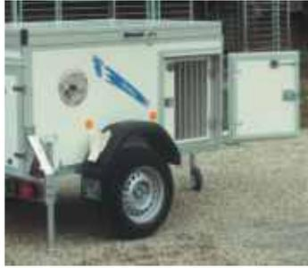
Komplett verschraubt für langlebige Aufbaustabilität und problemlosen Austausch von Teilen bei evtl. Beschädigung. Sicherheit serienmäßig: 1 Rohrstütze hinten, 2 Unterlegkeile.
