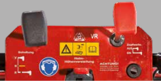
Übersichtliches Armaturenbrett mit Holmhöheinstellung und Schaltschema-Anzeige
