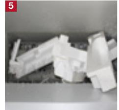
Ein effizienter Vorbrecher mit zwei Reißmesserwellen zerkleinert die Teile in 20 - 50 Millimeter kleine Stücke.
