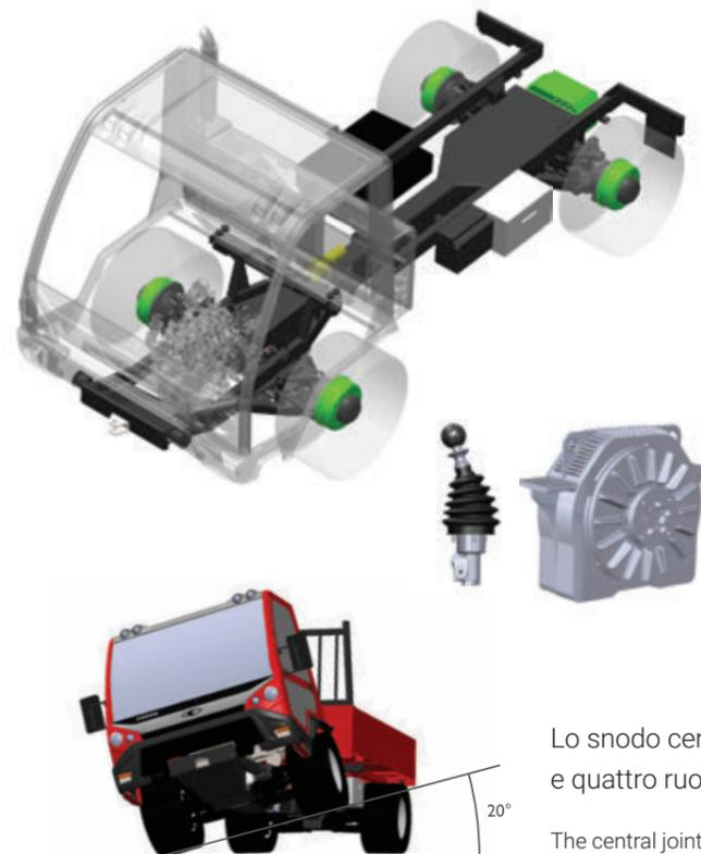
Lo snodo centrale lineare incorporato permette di mantenere costantemente e quattro ruote a contatto con il suolo anche nei fondi più dissestati.
