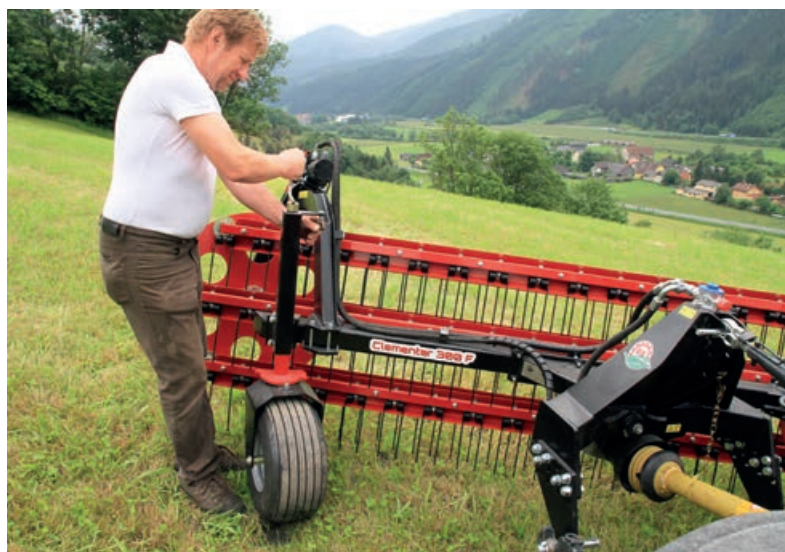
Zwei großdimensionierte, nahe an den Zinken laufende Stützräder sorgen auch in unebenem Gelände für eine gute Bodenanpassung.
