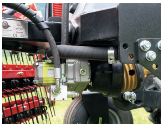
Die Pumpe für den hydraulischen Antrieb sitzt am Gerät und wird mittels Zapfwelle angetrieben.
