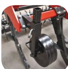
Ruote in ferro per la regolazione
