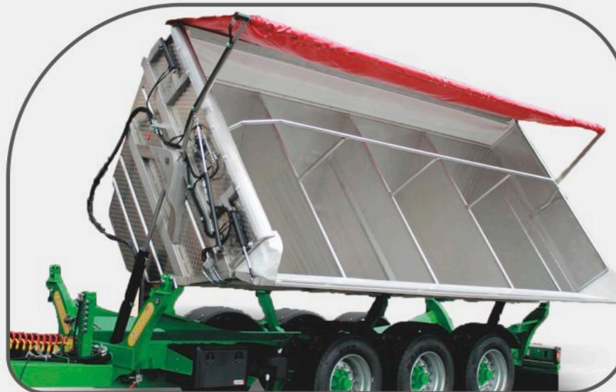
**Doppelte Überwände mit pneumatischer Öffnung**
