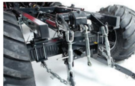
Sollevatore con leveraggi per attacco a tre punti posteriore.
