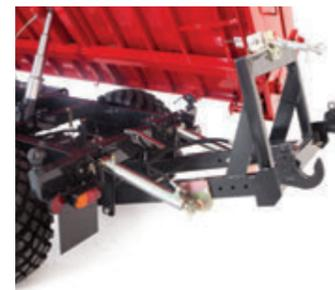
Porta-attrezzi posteriore idraulico con attacco a tre punti, removibile.
