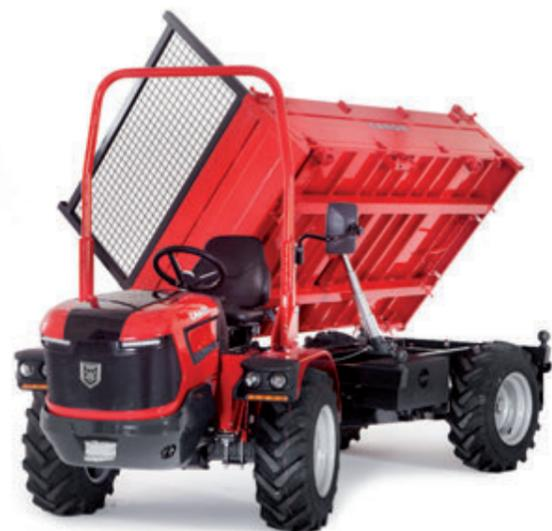
Pianale di carico rinforzato con sponde in tubolare, ribaltabile trilaterale e apertura automatica della sponda posteriore
