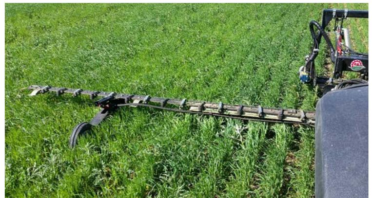
Mechanische Unkrautbekämpfung mit hydraulisch höhenverstellbarem Tastrad
