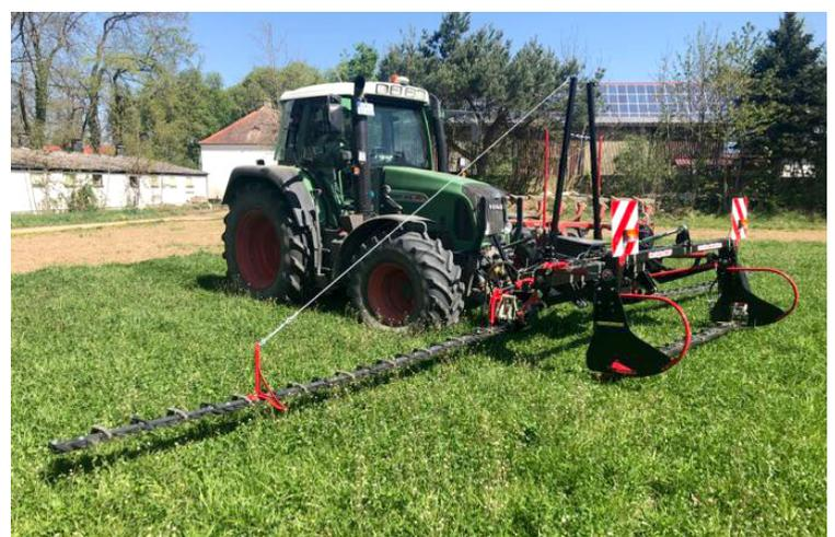
Mechanische Unkrautbekämpfung durch Abspannung der Seitenschneidwerke
