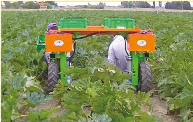
La macchina ECOGREEN MULTIS è una macchina da raccolta estremamente versatile. Grazie allo spazio utile dal suolo di 100 cm, consente la raccolta di frutta e ortaggi con piante di media altezza senza danneggiarle durante il passaggio.
