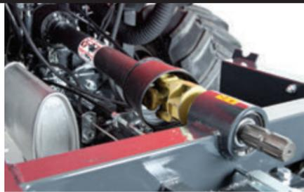
PTO centrale a 540 giri/min, con frizione idraulica indipendente
