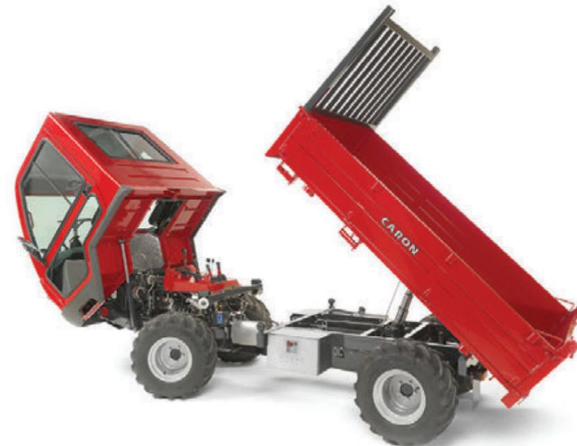
La cabina può essere sollevata in pochi secondi, grazie ad un pistone idraulico azionato manualmente. Gli interventi di manutenzione possono essere così eseguiti in modo facile e rapido.
