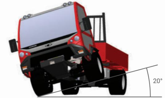
Lo snodo centrale lineare incorporato permette di mantenere costantemente le quattro ruote a contatto con il suolo anche nei fondi più dissestati.
