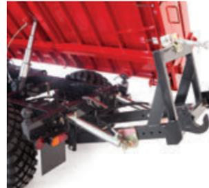
Porta-attrezzi posteriore idraulico con attacco a 3 punti, rimovibile
