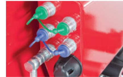
Distributore idraulico a 3 leve con regolatore di flusso e 5 innesti rapidi dietro la cabina
