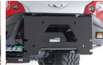
Variante idraulica con uscite anteriori e piastra porta-attrezzi
