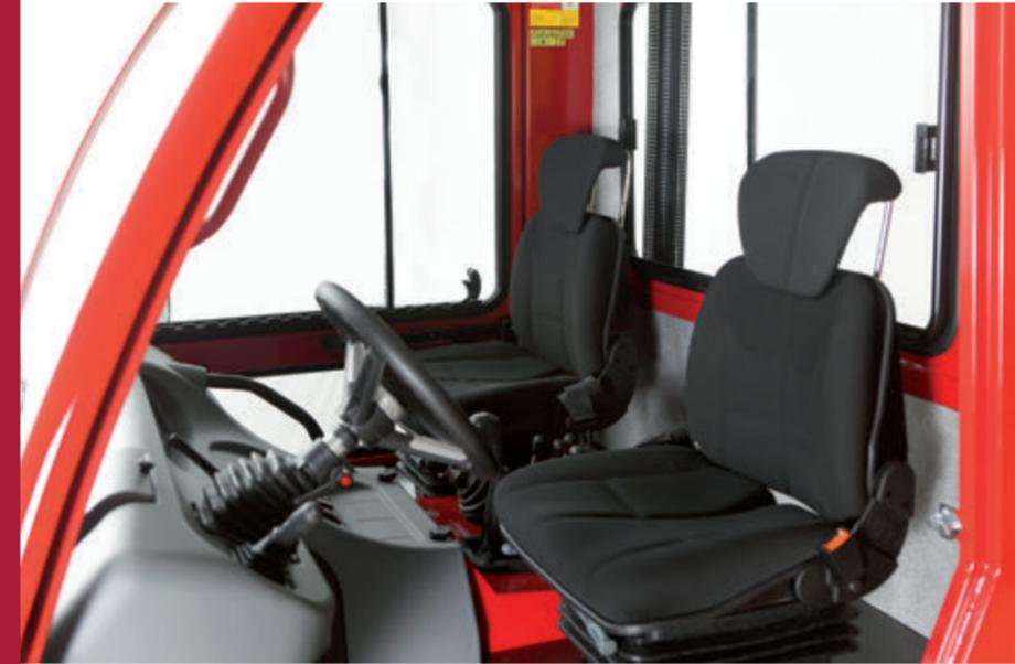
Nella progettazione della cabina ogni aspetto è curato per garantire il massimo comfort: il piantone dello sterzo è regolabile manualmente in altezza e inclinazione e i sedili anatomici hanno ampie possibilità di regolazione della seduta, dello schienale e del molleggio.
