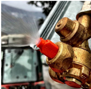
Abdriftarme Injektordüse Ugelli ad'iniezione d'aria a bassa deriva Anti-drift air injection nozzle
