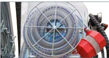
IT: Avvolgitore + caricabotte / EN: Hose reel and ejector / FR: Enrouleur et tuyaux injecteur / DE: Aufrolle und Ejektor / ES: Enrolladore y hydrocargador
