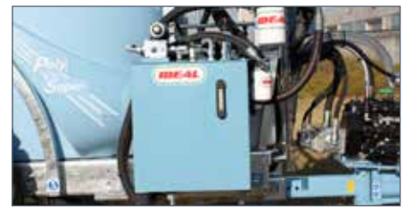
IT: Impianto idraulico indipendente / EN: Independent hydraulic circuit / FR: Circuit hydraulique indépendant / DE: Autonome Hydraulikanlage / ES: Circuito hidráulico autónomo
