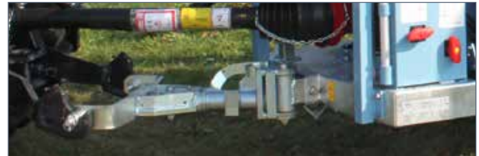
IT: Timone articolato con cuscinetti / EN: Tracker drawbar with bearings / FR: Attelage articulé avec roulements / DE: Gelenkdeichsel mit Lager / ES: Tiro articulado con cojinetes
