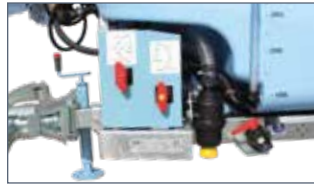
IT: Valvola di non ritorno sul risciacquo (su portati) / EN: Non-return valve on rinsing device (on mounted versions) / FR: Rinçage Ecoplus (sur portés) / DE: Rückschlagventil Spülsystem (bei aufgesetzten Modellen) / ES: Válvula de no retorno para el enjuague (en versiones suspendidas)
