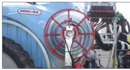
IT: Avvolgitore idraulico + caricabotte / EN: Hydraulic hose reel and ejector / FR: Hydraulique Enrouleur et tuyaux injecteur / DE: hydraulischer Aufrolle und Ejektor / ES: Enrolladore hidráulico y hydrocargador
