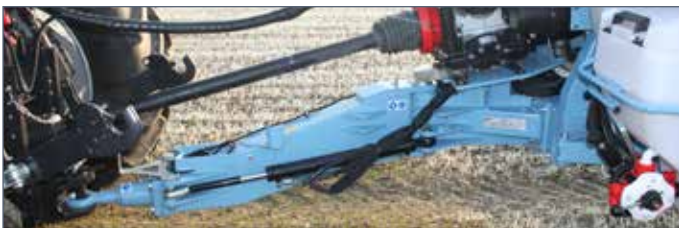
IT: Timone articolato con sterzata assistita / EN: Tracker drawbar with assisted steering / FR: Attelage articulé avec direction assistée / DE: Lenkdeichsel mit unterstützter Lenkung / ES: Tiro articulado con dirección asistida.
