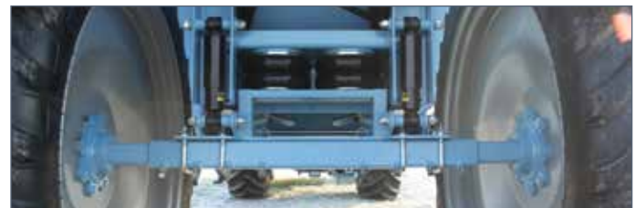
IT: Sospensioni assale con 2 pistoni a sfera d'aria / EN: Axle suspension - 2 air pistons / FR: Suspension d'essieu 2 piston d'air / DE: Federung Achse 2 Luft Kolben / ES: Suspensión dell'eje 2 pistones de aire
