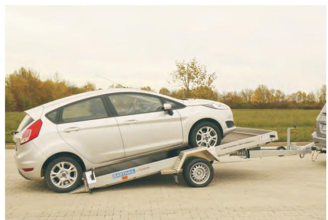
QM 1801 mit Zubehör Kotflügel aus Alu-Riffelblech. Falls der Radstand länger ist, als bei diesem PKW, muss ein Hydraulikzylinder montiert werden.
