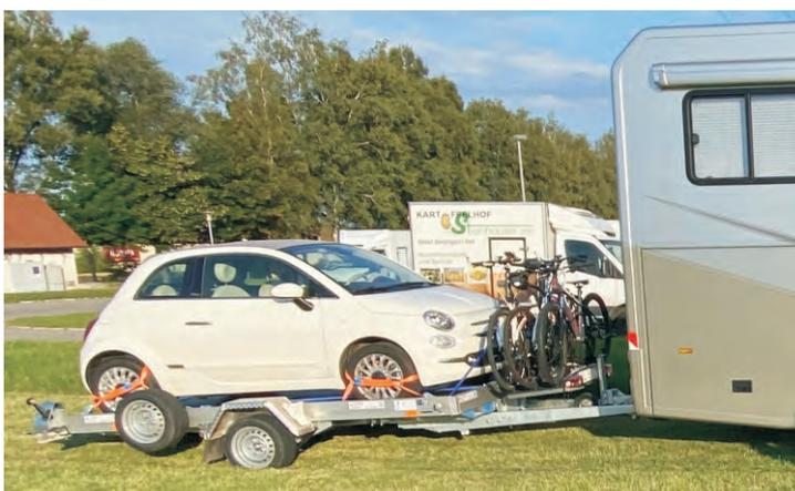
QM 1801 mit Zubehör Kotflügel aus Alu-Riffelblech, Ersatzrad mit Halterung, Fahrradständer auf der V-Deichsel.
