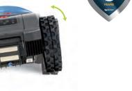
Sistema modulare con giunto snodato dei corpi del robot assicurando una elevata capacità di trazione.
