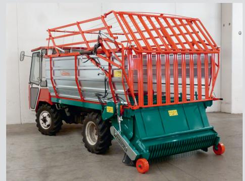
**Der LB-Ladewagen eignet sich wegen seines geringen Eigengewichts und seiner guten Leistungen auch gut für den Aufbau auf ältere und schwächere Typen von Transportern.**
