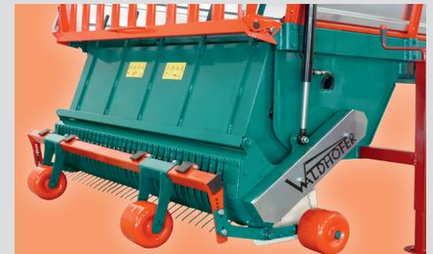
Die auch hinten in der Breite verstellbaren Pendel-Tastrollen am über 2 m breiten Pick-Up, passen sich gut an alle Bodenunebenheiten an und ermöglichen eine saubere Futteraufnahme.
