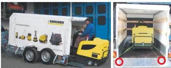
Flacher Auffahrwinkel durch Absenkung und lange Ladeklappe.
