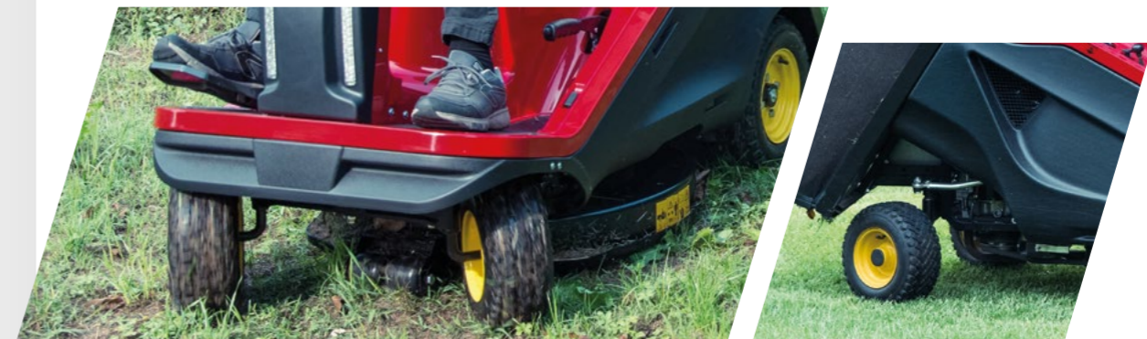
GTM – Vorderradlenkung GTR – Hinterradlenkung
