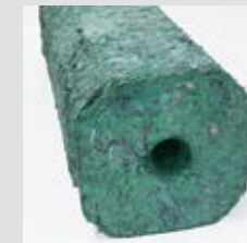
Verdichteter Block aus XPS-Trittschallplatten
