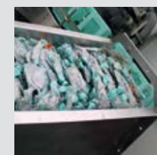
Verdichtete PET-Flaschen am Auslauf
