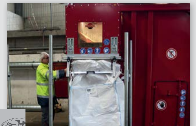
THE PANTHER BOX 800, Absackstation für verdichtetes KMF-Material
