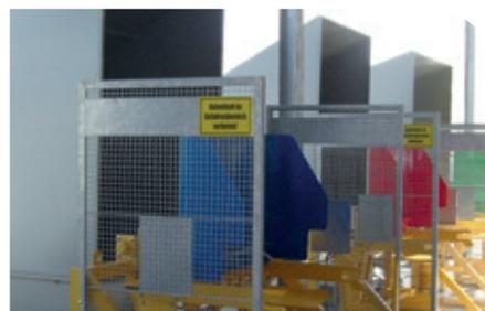
Il dispositivo di ribalta per contenitori da 660 a 1100 litri può essere utilizzato per ogni tipo di installazione
