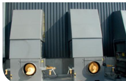
Compattatori a coclea con guide di centraggio per il posizionamento preciso dei contenitori
