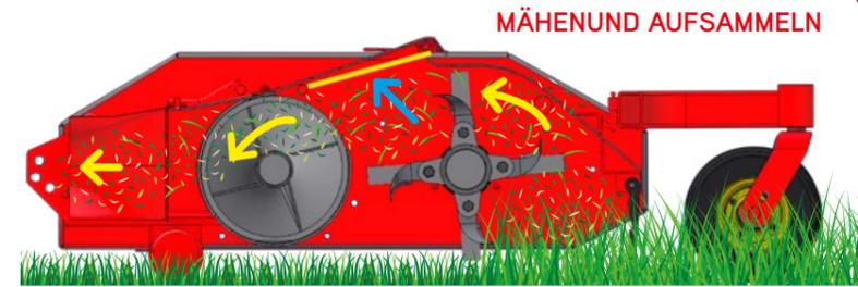
**Der GF3x1PLUS** gibt dem Nutzer die Möglichkeit zwischen Sammeln und Mulchen zu wählen. Beim PG erfolgt die Umschaltung hydraulisch, beim TURBO1-2-4 mechanisch per Handhebel. Die in der Abbildung dargestellte Klappe gibt den Weg für das Mähgut zum Aufsammeln frei oder leitet es direkt auf den Boden ab.
