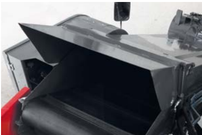
Hydraulischer Abweiser zur Vermeidung von Produktlecks an windreichen Tagen.
