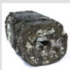
Blocco compresso di bitume/catrame in EPS
