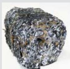
Blocco compattato ottenuto da pannelli anti-calpestio in EPS
