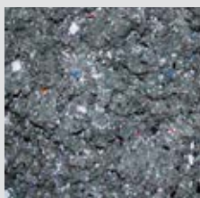
Materiale trattenuto dalle griglie di depurazione / fanghi residuati
