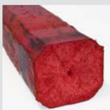
Blocco compresso di granuli di EPP
