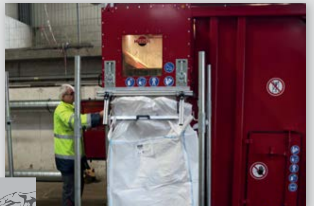
THE PANTHER BOX 800, stazione di riempimento sacchi per materiale in MMMF compattato
