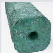
Blocco compattato ottenuto da pannelli anti-calpestio in XPS
