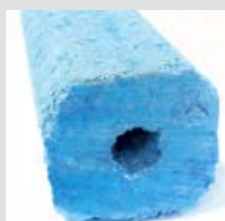
Blocco compattato ottenuto da pannelli isolanti in XPS
