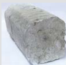
Blocco compattato ottenuto da espanso rigido PUR
